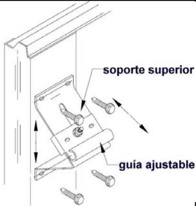
Ajuste el soporte superior de la guía vertical para asegurar que la separación entre la guía y la pared frontal queden en ángulo en cada bisagra.
