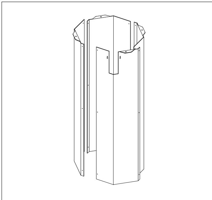
2 - Componer la estructura hexagonal usando los tornillos de cabeza convexa en equipamiento. Es muy importante ensamblar los tres elementos en posición vertical sobre una superficie de perfecta planaridad, para un plano de apoyo de la brida de cierre fiable. **Atención: la cabeza del tornillo deberá quedar en el interior de la caja.** Véase la figura contigua.
