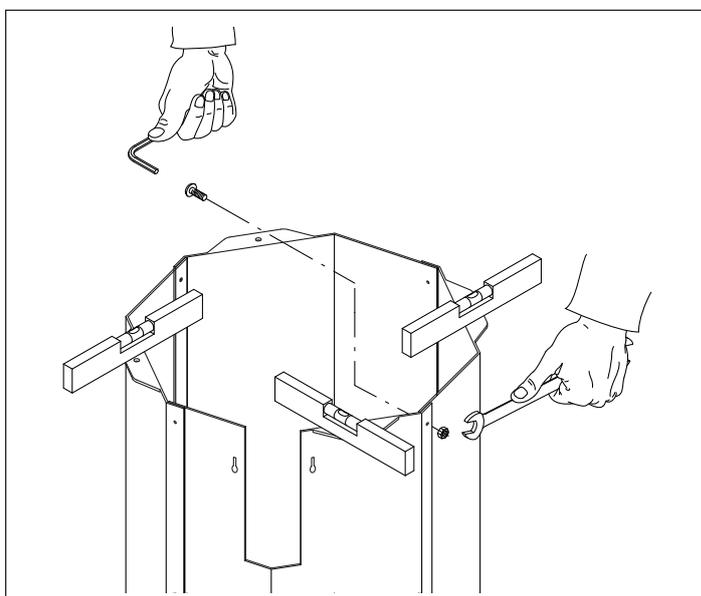
3 - Antes de fijar la brida superior, montar la protección metálica del tubo corrugado de 50 mm de diámetro, que estará apoyado en el suelo para su conexión eléctrica a la centralita de mando. Véase las figuras contiguas.
