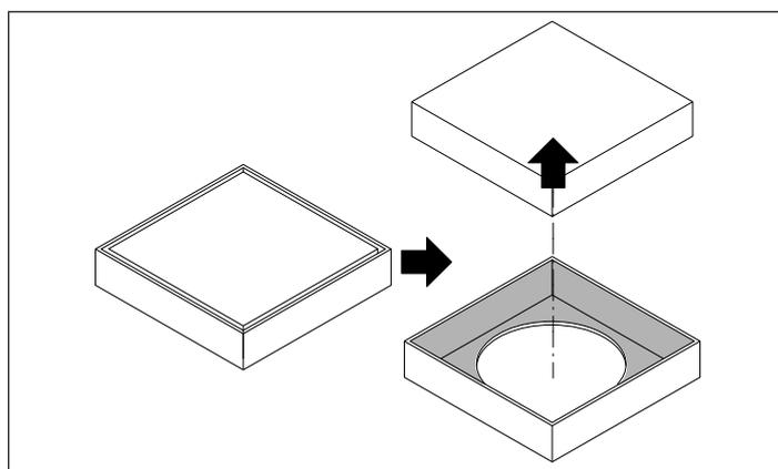
9 - Disponer una caja de derivación cerca (máx. 2/3 m) del disuasor (Ref. S), en la cual dejar aproximadamente 1 m de cable excedente. Durante la introducción del disuasor, gracias a esta derivación se podrá recuperar/soltar el cable.
