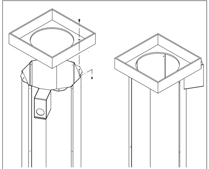
5 - Montar las grapas como muestra la figura, bloqueándolas en posición con la arandela y el tornillo M10 de cabeza hexagonal. Doblarlas conforme a la cimentación.
