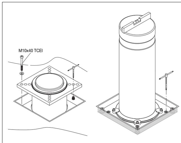
14 - Comprobar que la distancia entre la brida del disuasor y el borde superior de la caja/suelo sea de 23-24 mm.
