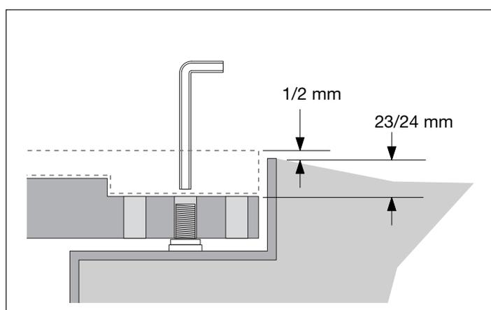
15 - **Después de haber puesto el disuasor en estado de reposo, sacar los bloques en el anillo de guía del tubo y colocar la brida pisable.**
