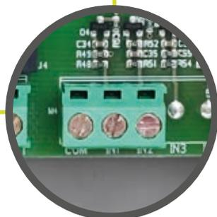
ONE.4 está dotado de dos entradas para mandos cableados: es posible asignar a cada entrada cada una de las 4 salidas presentes mediante la configuración de los parámetros correspondientes.
